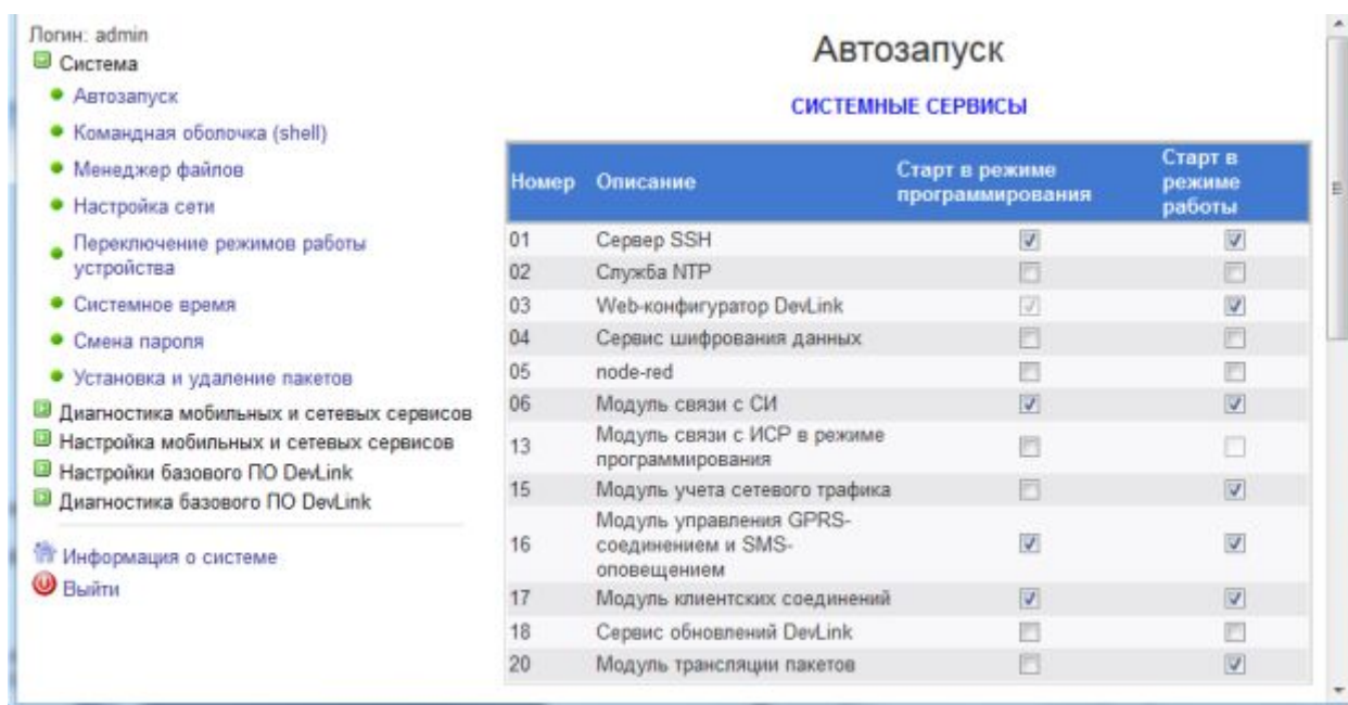
Рисунок 6 – Web-конфигуратор контроллеров DevLink. Модуль управления GPRS-соединением и SMS-оповещением
